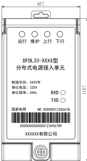
图 1 接入单元外观尺寸示意图
